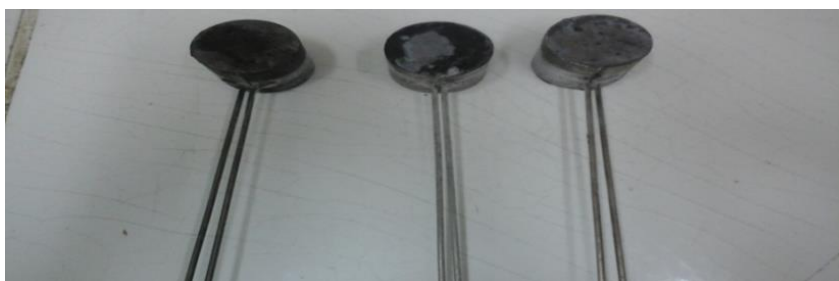
Figura 2.38. Dispozitive pentru determinarea stabilității
