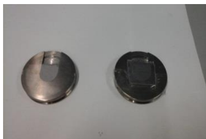
Figura 2.18 Suport probă pentru analiza XRD
