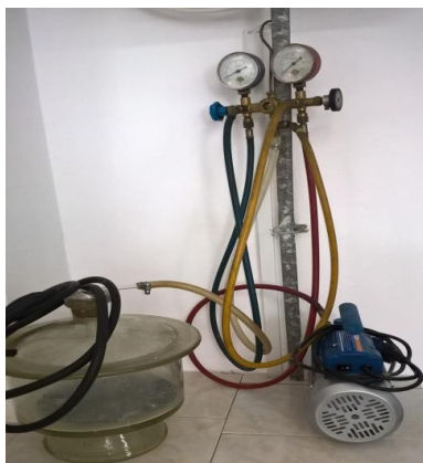
Figura 2.39 Instalația pentru realizarea testului de absorbție a apei
