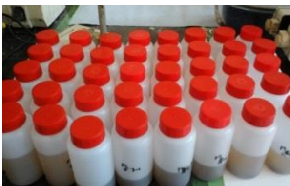
Figura 2.12 Recipiente cu probe în soluție de \text{NaOH} la diferite concentrații
