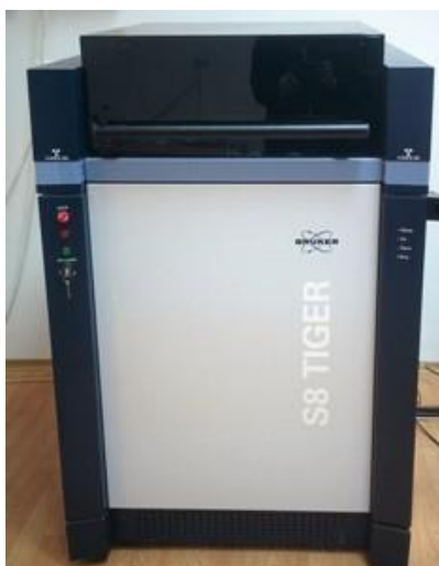
Figura 2.10 Spectrometru de fluorescență cu raze X de tip S8 Tiger
