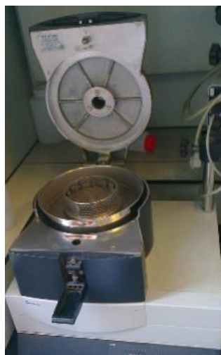
Figura 2.5 Moară cu rotor de tip Retsch ZM 100
