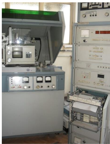
Figura 2.19 Difractometrul cu raze X – DRON 3
