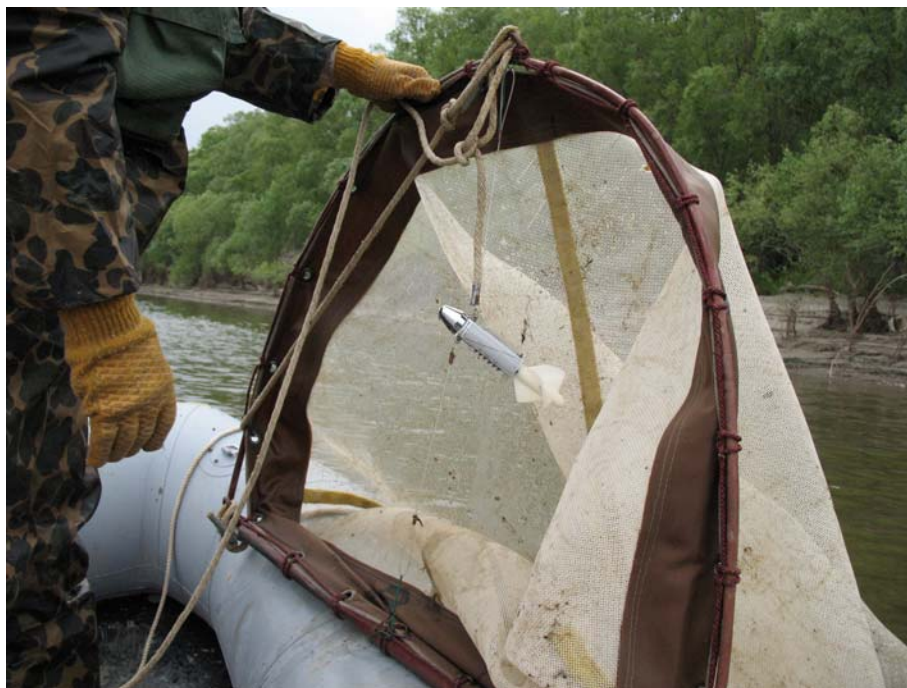
Fig. 20: Fileu, echipat cu un curentmetru pentru determinarea vitezei apei și a volumului filtrat
