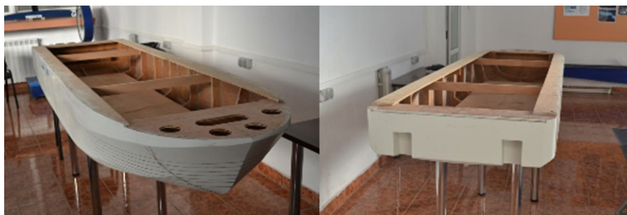
Figura 3.2. Model navă redus la scară. Scara 1:16. [78]
